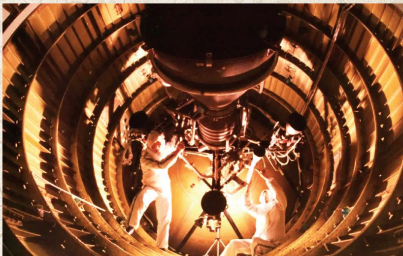
▲ 2003年5月15日，中国运载火箭技术研究院工作人员在火箭总装现场对发动机进行调试
