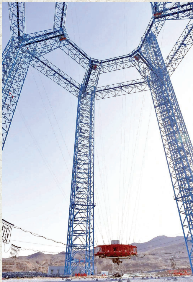
▲ 2019年11月14日，中国首次火星探测任务着陆器正在试验场进行悬停避障试验。中国首次火星探测任务于2014年启动研制，2016年正式批复立项，计划2020年择机实施，目标通过一次发射实现对火星环绕、着陆及巡视，对火星展开全球性、综合性的环绕探测
